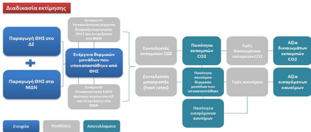
Διάγραμμα 3.3: Διαδικασία εκτίμησης οικονομικών επιδράσεων από την παραγωγή ενέργειας από ΘΗΣ σε όρους εξοικονόμησης εισαγόμενων καυσίμων, δικαιωμάτων CO 2 και εξωτερικού κόστους από συμβατική ηλεκτροπαραγωγή
